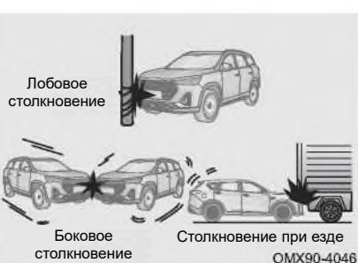
Подушка безопасности водителя и подушка безопасности переднего пассажира могут не сработать, если автомобиль попал в боковое или заднее столкновение, если он перевернулся или попал в лобовое столкновение на низкой скорости.
