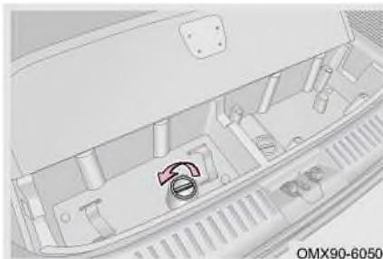
Шаг 1: Откройте заднюю дверцу, поверните крышку против часовой стрелки, чтобы снять её.
