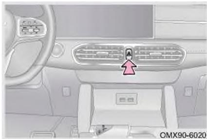
Нажмите выключатель аварийной сигнализации, одновременно замигают указатели поворота и индикатор указателей поворота на приборной панели; Нажмите переключатель еще раз, указатели поворота и индикатор погаснут.
