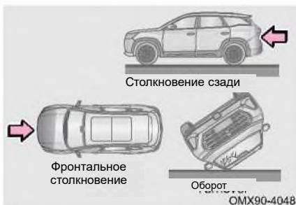
Передняя боковая подушка безопасности и шторка безопасности могут не раскрыться, если автомобиль подвергся фронтальному или заднему столкновению, опрокидыванию или боковому столкновению на низкой скорости.
