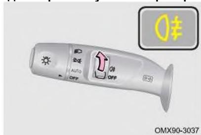
При переведении питания автомобиля в режим ON и включении ближнего света, нажмите кнопку в направлении «0#» один раз, чтобы включить заднюю противотуманную фару; Поверните кнопку в сторону «0#» еще раз, чтобы выключить заднюю противотуманную фару.
