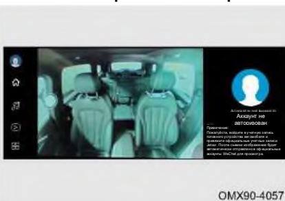
Нажмите на изображение в автомобиле на экране приложения, заднее изображение будет отображаться на аудиоэкране в режиме реального времени, что удобно для водителя, чтобы наблюдать за детьми на заднем сиденье, и поддерживает автоматическую отправку фотографий на WeChat мобильного телефона.
