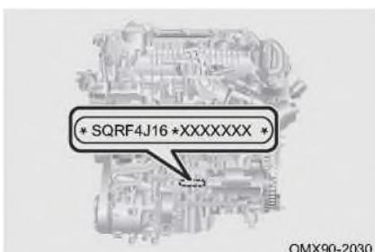
Номер двигателя указан на блоке цилиндров.
