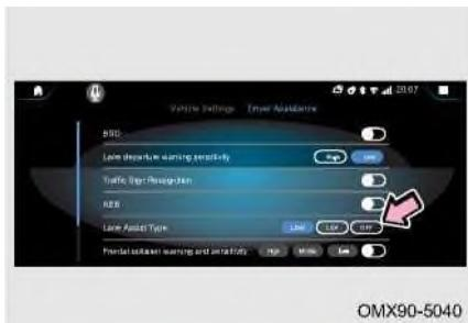
Тип помощи при движении по полосе может быть установлен на систему предупреждения о выходе из полосы движения (LDW), систему помощи при удержании в полосе движения (LKA) или ВЫКЛЮЧЕН через аудиосистему.
