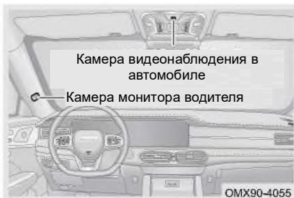
Система мониторинга водителя в основном распознает состояние водителя с помощью камеры монитора водителя (DMS).
