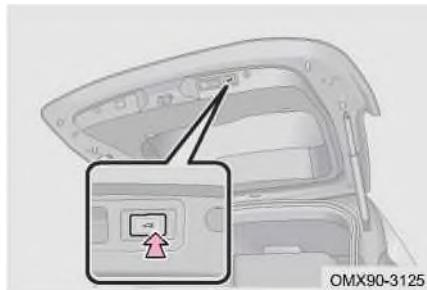
Когда дверь багажного отделения с электроприводом откроется, нажмите переключатель двери багажного отделения, чтобы закрыть дверь багажного отделения.
