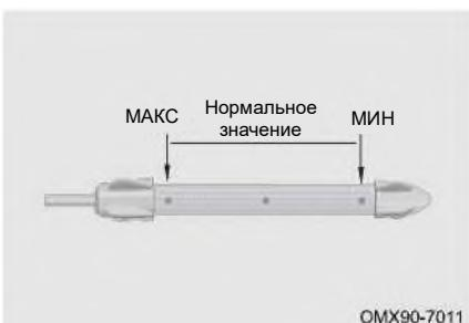
При выключенном и остывшем двигателе проверьте уровень масла с помощью щупа.
