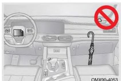
Ничего не прикрепляйте или прислоняйте к таким областям, как приборная панель, рулевое колесо и нижняя часть приборной панели. Эти предметы могут стать травмирующими при срабатывании подушки безопасности водителя или переднего пассажира.
