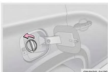
Шаг 2: Медленно поверните крышку топливного бака против часовой стрелки, чтобы снять её.
