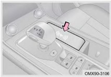
Когда питание автомобиля переключается в режим ON, беспроводная зарядка начинает работать после помещения мобильного телефона в зону обнаружения беспроводной зарядки, и " " индикатор комбинации приборов всегда включен; В случае сбоя беспроводной зарядки всегда горит индикатор " " на приборной панели.
