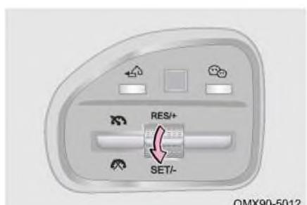
Если скорость автомобиля находится в пределах от 40 до 130 km/h, один раз переместите кнопку на рулевом колесе в положение «SET/-», чтобы установить текущую скорость в качестве круизной и войти в режим круиз контроль, индикатор «⟳» на приборной панели остается включенным.
