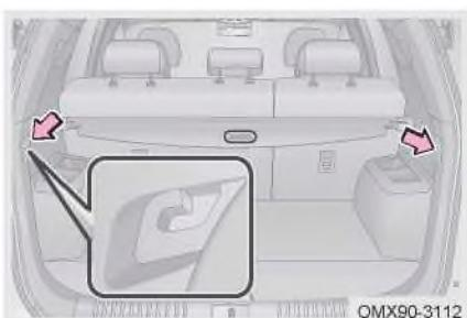
Потяните за ручку, чтобы натянуть шторку для багажа в прорези с обеих сторон и убедитесь, что она надежно зафиксирована в прорезях.
