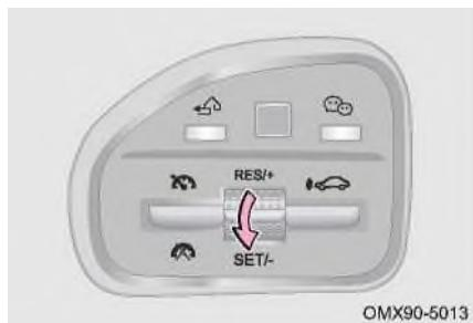
Включите питание автомобиля в режим ON, один раз переместите кнопку на рулевом колесе в положение «», чтобы войти в состояние перед круиз контролем, и индикатор «» на приборной панели останется включенным. В предкрайсерском режиме, когда впереди нет автомобиля и скорость автомобиля превышает 30 km/h, один раз переместите кнопку на рулевом колесе в положение «SET-», система адаптивного круиз-контроля активируется, а индикатор «» на комбинации приборов продолжает гореть.
