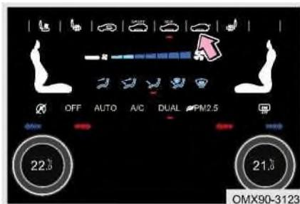
Нажмите кнопку открытия задней двери на дисплее кондиционера, чтобы открыть заднюю дверь.
