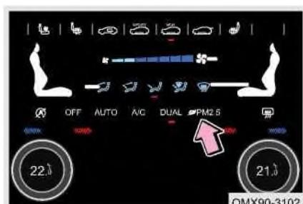
Нажмите кнопку очистки воздуха на экране управления кондиционером, чтобы активировать функцию очистки воздуха. Нажмите кнопку очистки воздуха на главном экране аудиосистемы, чтобы открыть экран настройки очистителя воздуха.
