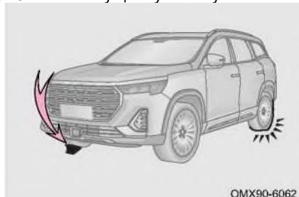
Шаг 1: Поместите блок под шину по диагонали напротив спущенной шины, чтобы предотвратить скатывание автомобиля.
