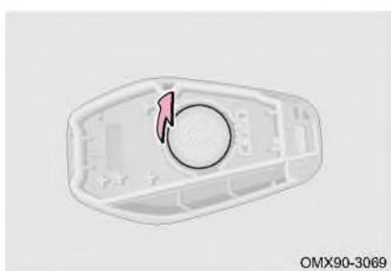
Шаг 3. С помощью отвертки, обмотав наконечник защитной лентой, извлеките аккумулятор, а затем установите новый аккумулятор.
