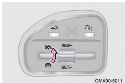
Во время движения автомобиля один раз переместитесь в сторону "↗" для входа в круиз-систему, индикатор "⟳" на комбинации приборов загорится и начнет мигать. Переместитесь один раз в сторону "↖", чтобы выйти из системы круиз-контроля в процессе круиз-контроля.
