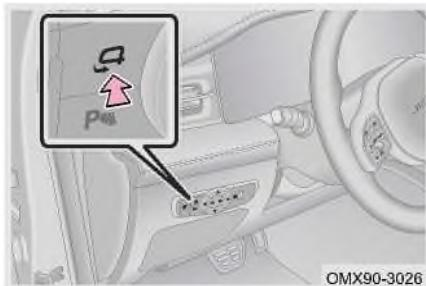
Работа с помощью переключателя: когда питание автомобиля включено, нажмите переключатель складывания на левом боковом переключателе приборной панели, чтобы автоматически сложить наружное зеркало заднего вида; Нажмите переключатель еще раз, чтобы зеркала выдвинулись автоматически.
