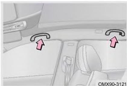
Вспомогательная рукоятка расположена по обеим сторонам пассажирской двери и задней двери. Располагаясь на сиденье, тело может поддерживаться вспомогательными ручками, установленными на обивке крыши. Крючок для одежды расположен на задней вспомогательной рукоятке.
