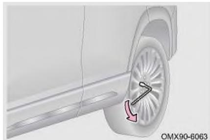
Шаг 2: слегка ослабьте колесный болт ключом для колесных болтов (примерно на пол оборота).
