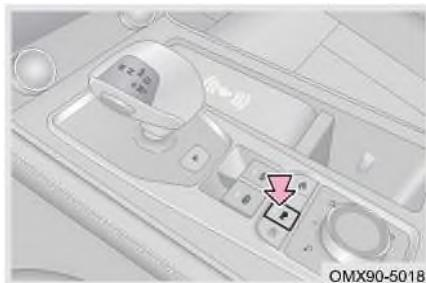
Нажмите переключатель APA на дополнительной приборной панели, загорится индикатор переключателя для входа в APA; Нажмите еще раз, индикатор погаснет, чтобы выйти из APA.
