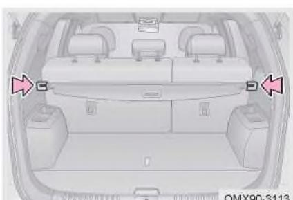
Нажмите на два конца шторки для багажа внутрь, чтобы снять/установить шторку. После того, как шторка снята, ее можно поместить в багажное отделение.
