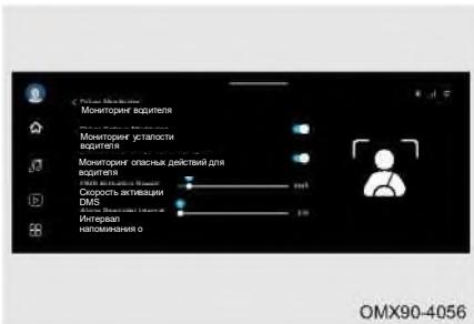
Система мониторинга водителя может включать/выключать соответствующие функции аудиосистемы, а также активировать настройку скорости и времени будильника.
