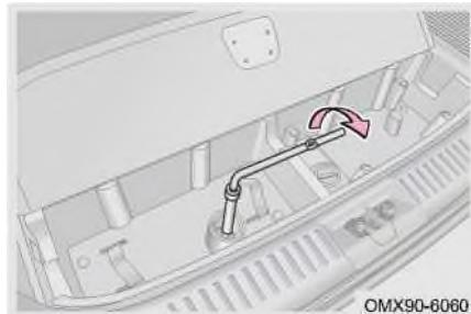
Шаг 2: Вставьте удлинитель колесного ключа в крепежный болт запасного колеса.
