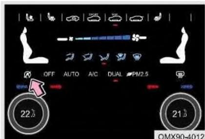
Нажмите выключатель пуска-остановки холостого хода, символ высветится, и система выключится; Нажмите выключатель пуска-останова на холостом ходу еще раз, выделение символа отменяется, и система включится.
